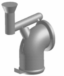
图 8 优化设计的浇注系统及铸件结构
