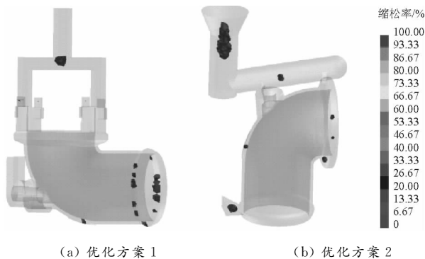
图 10 优化方案 1 和优化方案 2 的缩松的模拟过程
